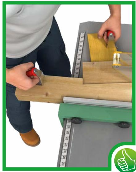
*Kreissäge: Keilschneiden mit Keilschneidelade*
