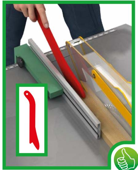
*Kreissäge: Schmale Werkstücke mit Schiebstock schneiden*
