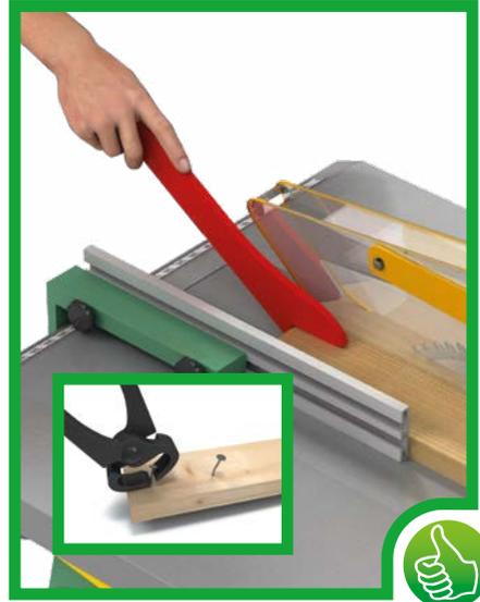
*Kreissäge: Werkstück ohne Fremdkörper schneiden*
