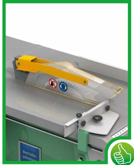
*Kreissäge mit selbst absenkender Schutzhaube verwenden*
